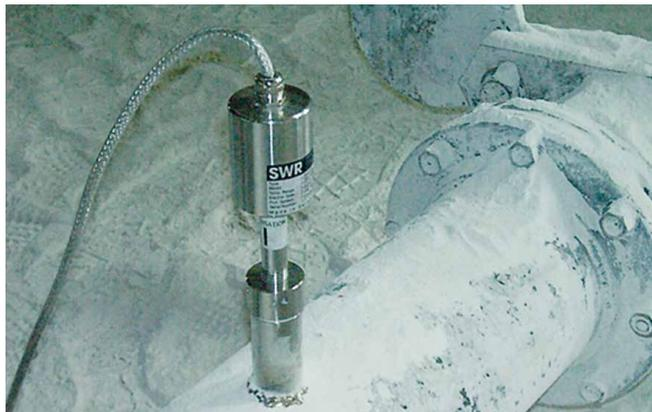
SolidFlow 2.0 é a última geração de sistemas de medição baseados em microondas para medir o fluxo de sólidos.
