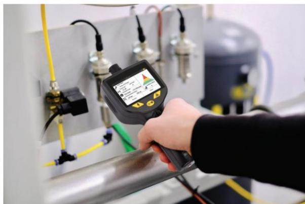
Detector de Vazamento Ultrassônico S531
