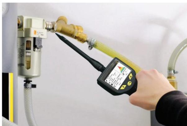
Detecção de vazamento com tubo de foco
