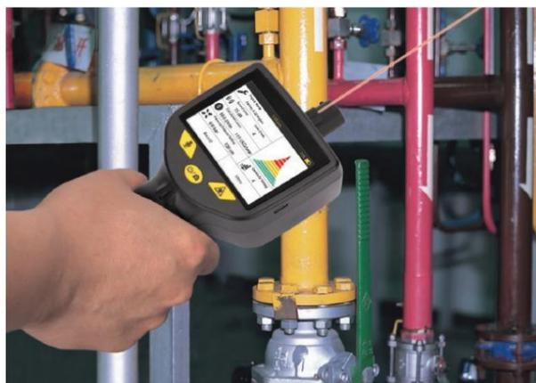
Detecção de vazamento à distância com o ponteiro laser integrado
