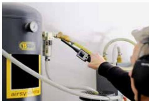
Deteção de vazamento com tubo de foco
