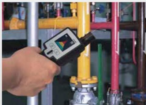
Deteção de vazamento à distância com o ponteiro laser integrado
