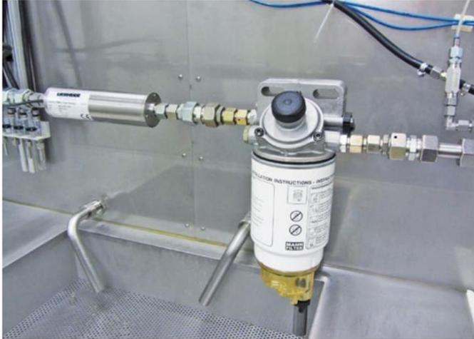
Sensor Litronic-FMS/RMH12 integrado em uma planta de teste e laboratório para monitorar a capacidade de desemulsificação de um filtro de óleo diesel.
