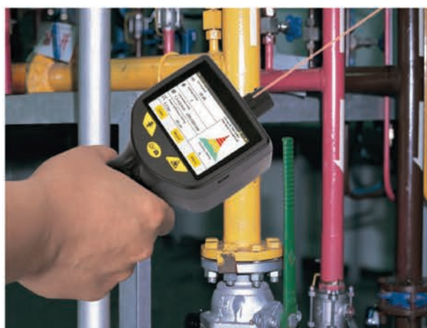
Detecção de vazamento à distância com o apontador laser integrado
