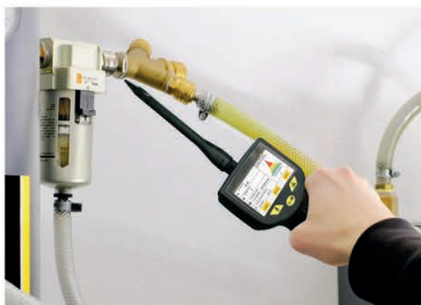
Detecção de vazamento com tubo de foco
